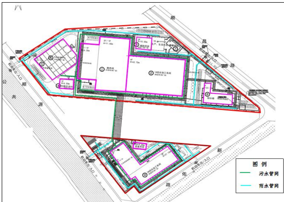
图 6.5-1 厂区内雨污管网图
